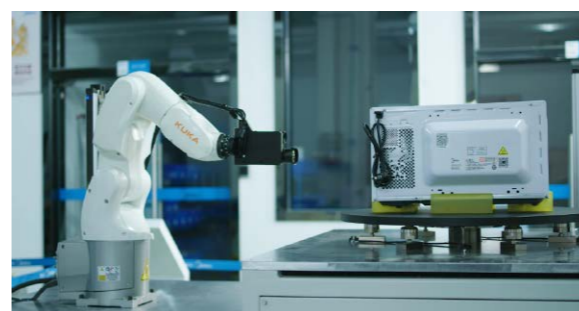
图 2-1-6 执行微波炉缺陷检测的工业机器人
