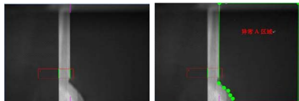
图 2-1-15 绝缘膜破损、丢失、褶皱问题检测实例
